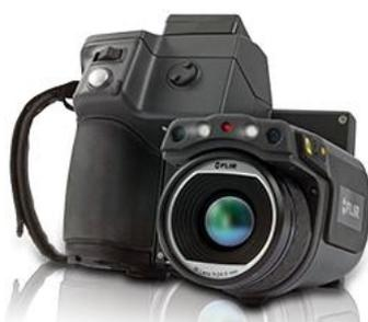
Figura 2.1- Câmera de Infravermelho.
