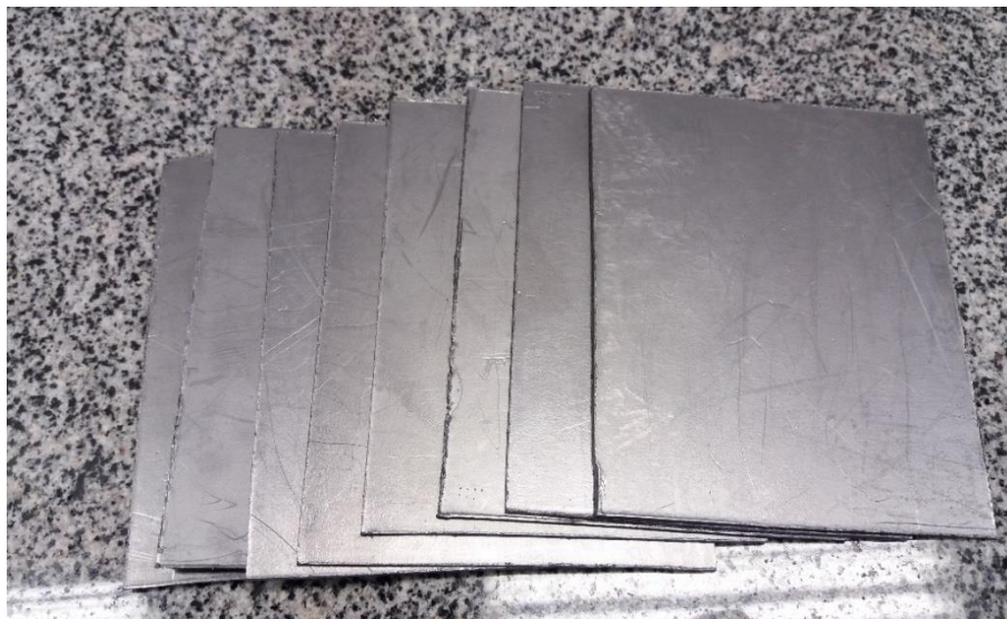
Figura 4.14 - Placas de grafite flexível de tela lisa com reforço metálico.
