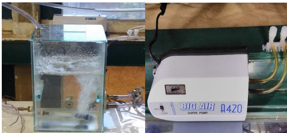
Figura 4.7 - Vista frontal do reator, visualização da entrada lateral, mangueira e pedra porosa (à esquerda) e compressor de ar Big Air A420 (à direita).
