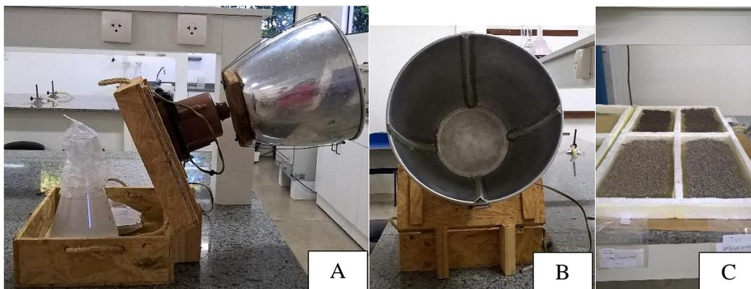
Figura 1. (A) e (B) Mini betoneira caseira usada para o revestimento das sementes de *Brachiaria brizantha*; (C) Tela para secagem das sementes.
