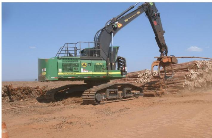
Figura 11 – Garra traçadora para desdobramento dos fustes.
