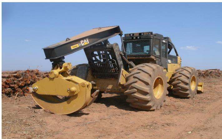
Figura 10 – *Skidder* para arraste dos fustes da área de colheita.
