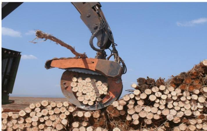
Figura 12 – Detalhes do desdobramento dos fustes por garra traçadora. Região do Alto Jequitinhonha – Minas Gerais (Foto do autor).
