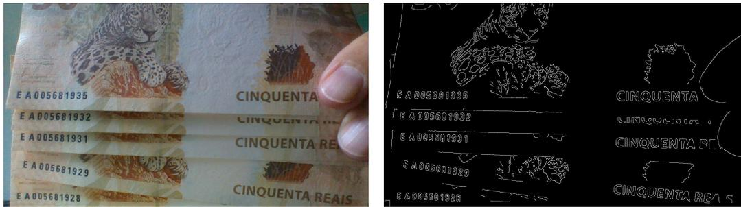
(a) Imagem antes da utilização do detector de bordas de Canny. (b) Imagem após a utilização do detector de bordas de Canny, com limiares mínimo e máximo, respectivamente, iguais a 0,2 e 0,4.
