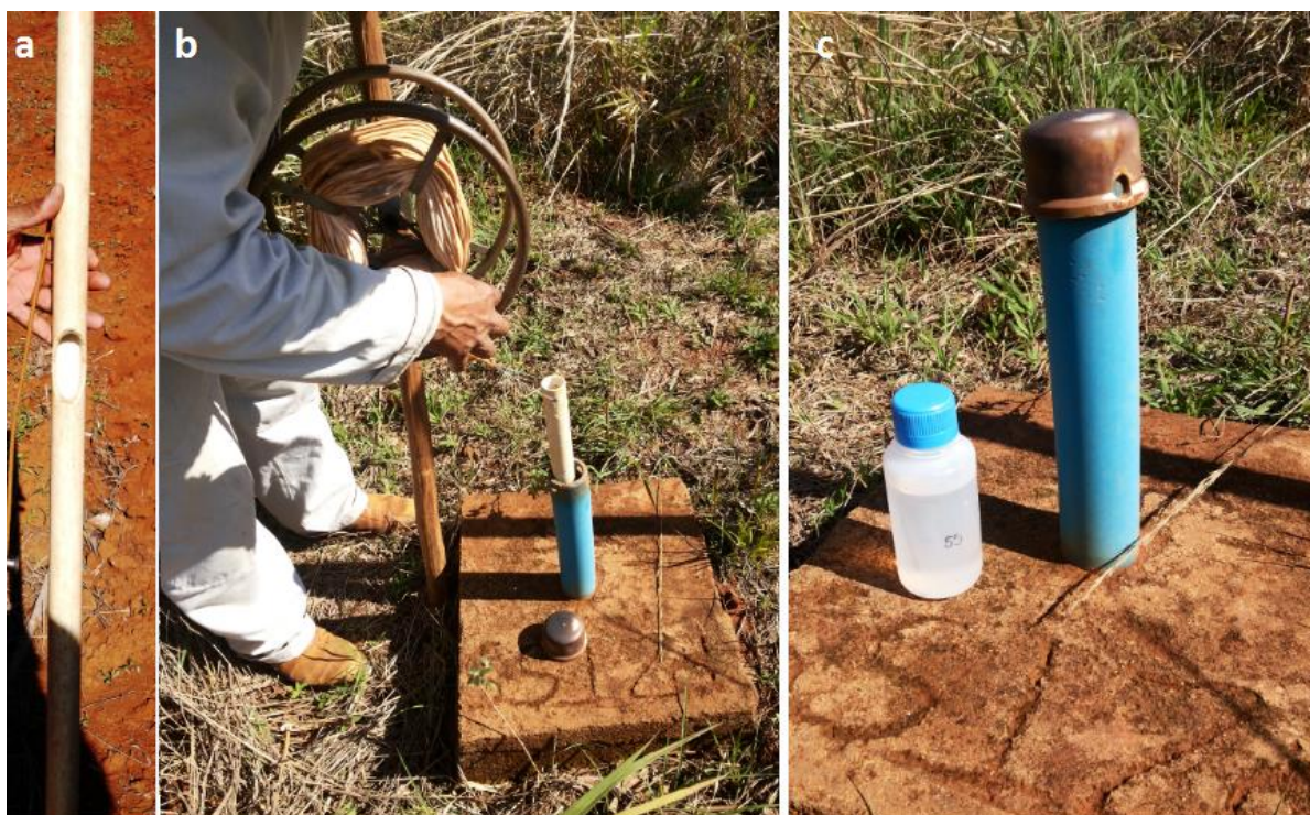
Figura 7 - a) Amostrador de PVC (tipo bailer), b) coleta e c) amostras nos frascos de polietileno.
