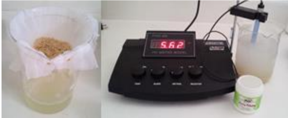
Figura 7. Filtração do grão da quinoa em voal para remoção das saponinas (esquerda) e correção da acidez com ácido cítrico (direita)
