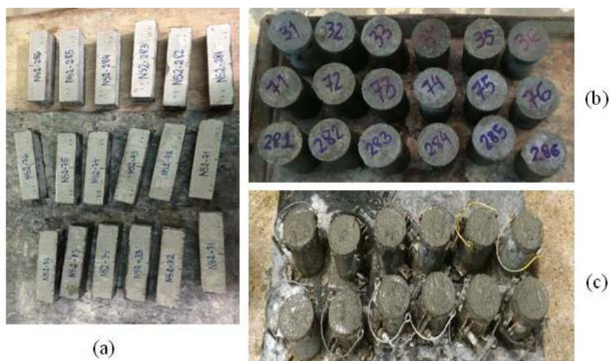
Figura 3-17: Corpos de prova pra ensaios de propriedades mecânicas: (a) Corpos de prova prismáticos de 4x4x16cm para ensaio de tração na flexão e compressão em cubos, devidamente identificados após a desforma; (b) Cilindros 5x10cm para resistência a compressão após a desforma; (c) Moldagem dos cilindros 20x10cm pra ensaio de módulo de elasticidade.
