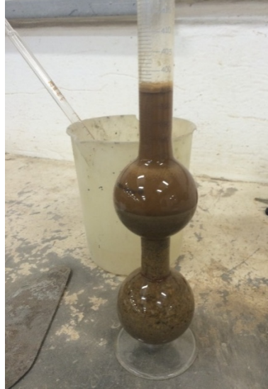
Figura 3-3: Ensaio de determinação da umidade superficial da areia – Frasco de Chapman.
