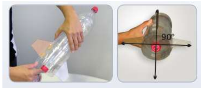
Figura 7: Montagem das aletas
