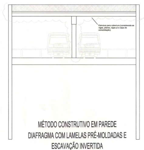
Figura 39 Método Cut-and-Cover Fonte: Adaptado dos Projetos METRÔ-DF (2009)
