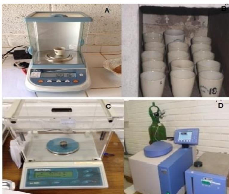
Figura 3.7. Pesagem dos cadinhos para determinação do teor de materiais voláteis (A); Cadinhos na mufla a temperatura de 700°C para determinação do teor de cinzas; Pesagem da amostra para ensaio de poder calorífico (C); Calorímetro PARR modelo 1341 (D).
