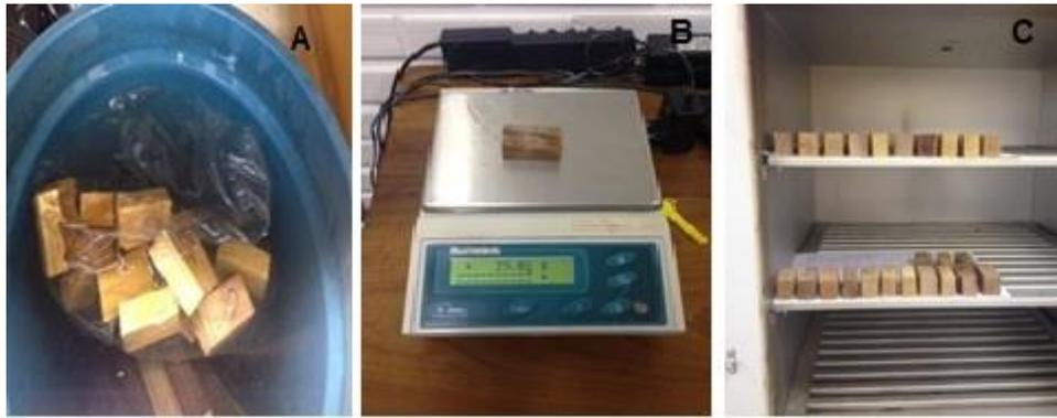
Figura 3.6. Saturação das amostras para obter o teor de umidade máximo das amostras (A). Pesagem das amostras para controle (B). Secagem das amostras em estufa para obter a massa seca (C).
