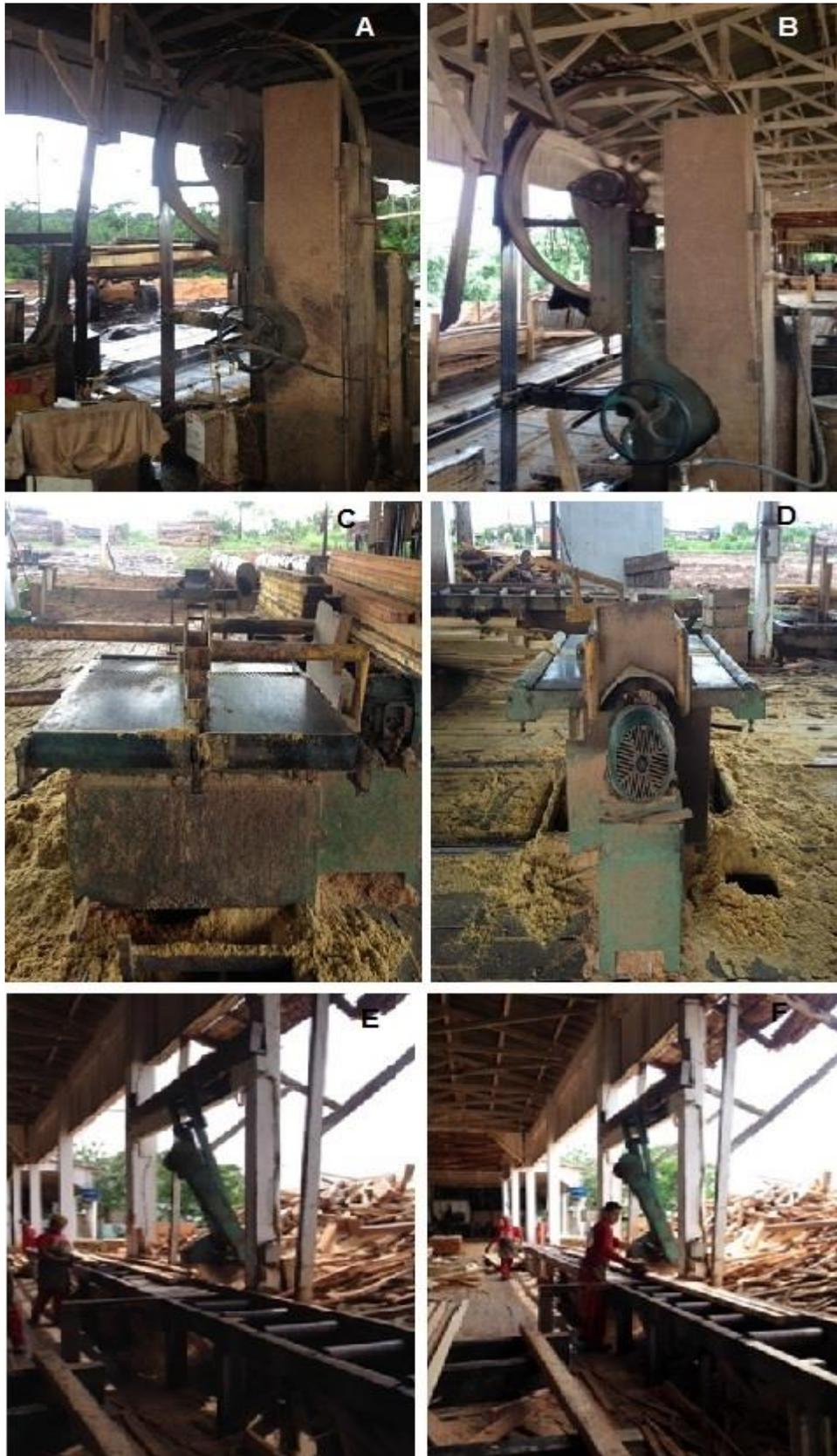
Figura 3.2. Máquina principal da serraria - Serra-de-fita vertical simples (A, B); Serra-circular simples responsável pelo canteamento das peças (C, D); Destopadeira responsável pelo destopamento das peças (E, F).
