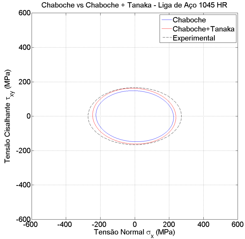
Figura B.14 – História de tensão resultante de simulação para o aço 1045HR com história de deformação (d) e amplitudes \varepsilon_a = 0,146\% e \gamma_a = 0,311\% - Caso N° 9.
