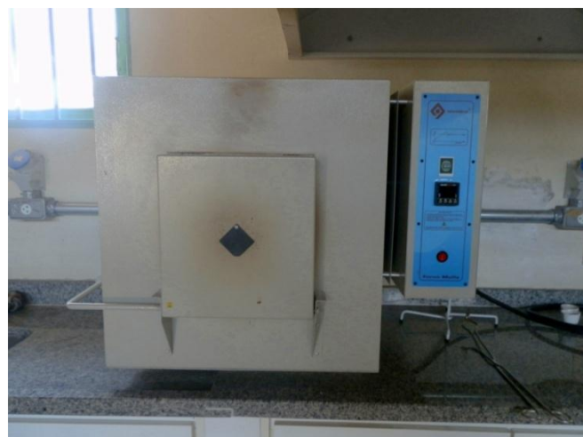
Figura 3. Mufla utilizada para análise do material volátil e cinzas.
