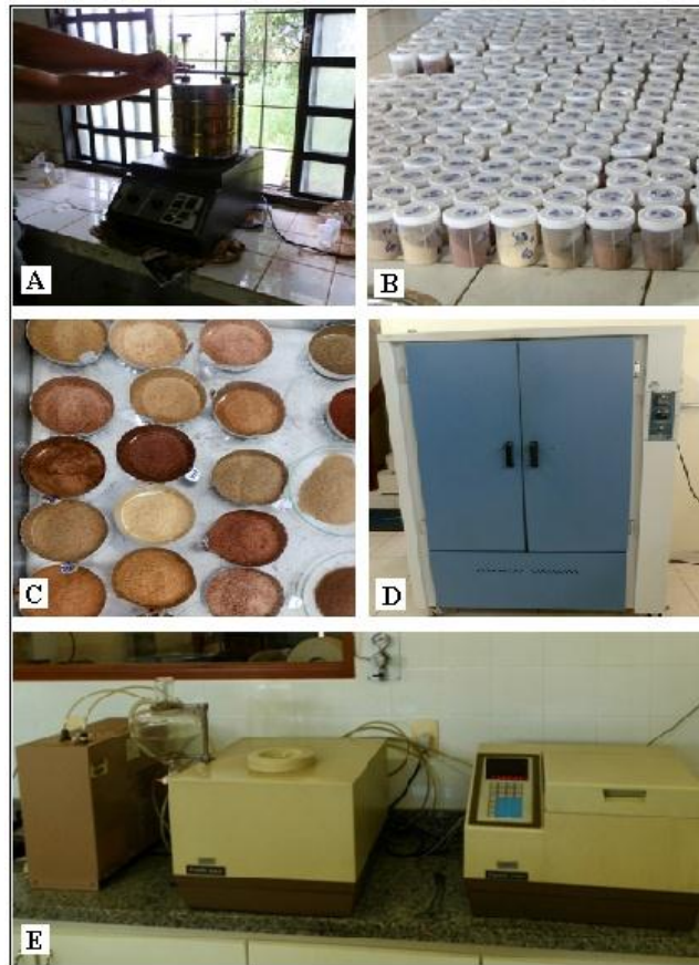
Figura 2. Peneiramento do material (A); Material utilizado para análises, imediata e PCS (B e C); Estufa utilizada para secagem do material (D); Bomba calorimétrica utilizada para análise de poder calorífico (E).
