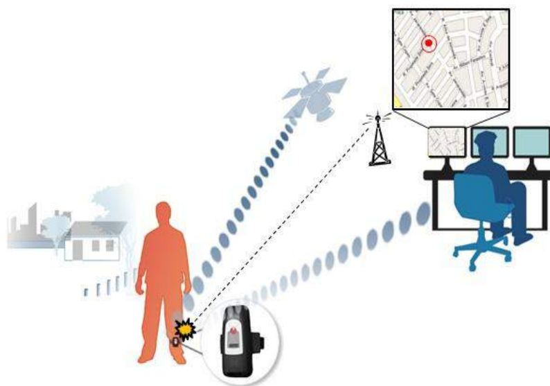
Figura 2 – Sistema GPS de uma peça – Fonte: Spacecom Monitoramento S/A.
