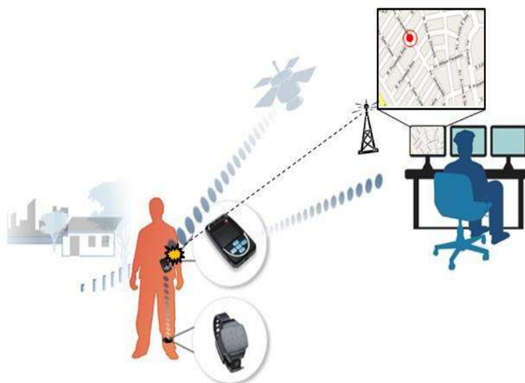
Figura 1 – Sistema GPS de duas peças – Fonte: Spacecom Monitoramento S/A.
