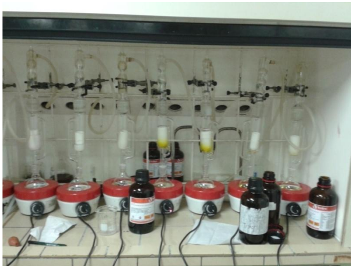
Figura 26. Processo de extração do óleo de dendê por solvente éter de petróleo, utilizando o aparelho o extrator Soxhlet.
