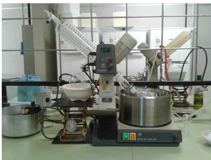
Figura 27. Rotoevaporador para recuperação do solvente por evaporação.
