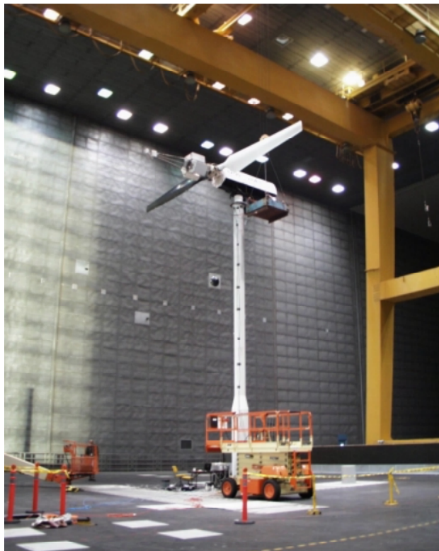
Figura 4.3: NREL Phase VI com 10,058m de diâmetro suportada por uma torre de 12,2m e diâmetro de 0,4m (Fonte: Hand et al. (2001a)).
