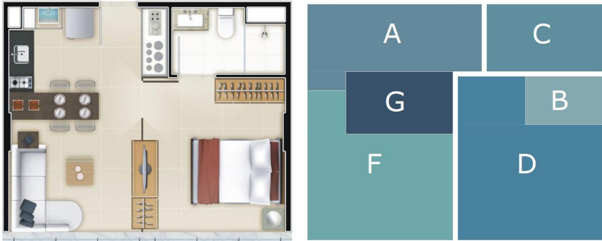
Figura 4.12 (a) e (b). (a) Planta baixa humanizada de unidade de um quarto da empresa consultada Via Empreendimentos. Fonte: Via empreendimentos. (b) Correspondente análise esquemática da planta da mesma unidade, onde as letras correspondem às áreas funcionais e os retângulos de diferentes cores representam as formas e dimensões destas áreas. Na figura, as funções correspondentes às letras são as que se seguem: (A) Cozinhar/ higiene de roupas, (B) Armazenamento de roupas, (C) Higiene individual, (D) Dormir/íntimo, (F) Estar/receber pessoas, (G) Comer.
