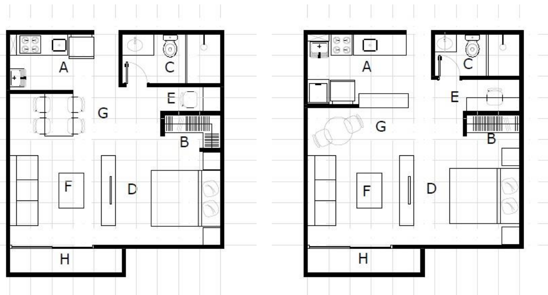
Figura 5.13. (a) Configuração correspondente da planta baixa no momento inicial, antes do início da etapa de atribuição de pesos, onde cada espaço tem a atribuição de peso padrão ( default ) 2; (b) configuração correspondente da planta baixa após um exemplo de preenchimento da questão 3 por um cliente e da atribuição dos seguintes pesos: (A) 3 (B) 1 (C) 1 (D) 3 (E) 3 (F) 2 (G) 1 (H) 2. fonte: (da autora)
