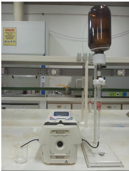
**Figura 7.** Sistema de extra o em fase s lida (SPE), otimizado segundo Sodr , *et al.* (2010).
