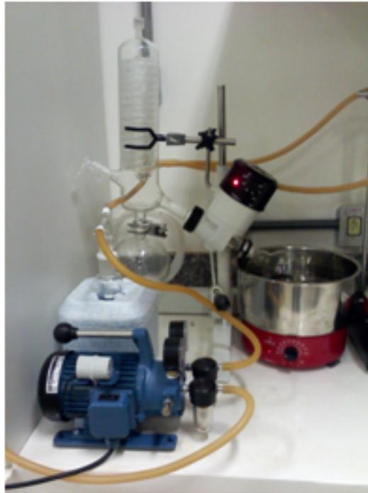
**Figura 9.** Sistema utilizado para a concentração das amostras em evaporador rotativo com banho de aquecimento e em atmosfera de vácuo. Disponível no laboratório do grupo de pesquisa em Automação, Quimiometria e Química Ambiental (AQQUA) da Universidade de Brasília.
