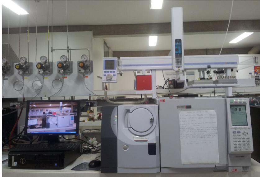
**Figura 10.** Cromatógrafo Gasoso acoplado a um Espectrômetro de Massas, Shimadzu CG-2010, da Central Analítica do Instituto de Química da Universidade de Brasília.
