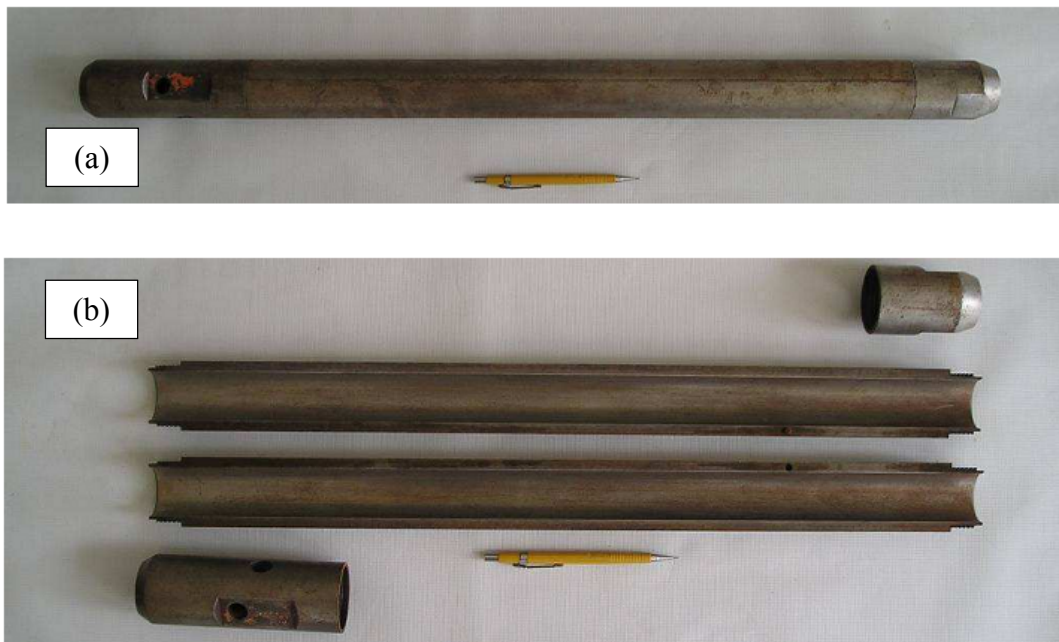
Figura 2.6. Amostrador-padrão "Raymond": (a) fechado (b) aberto.
