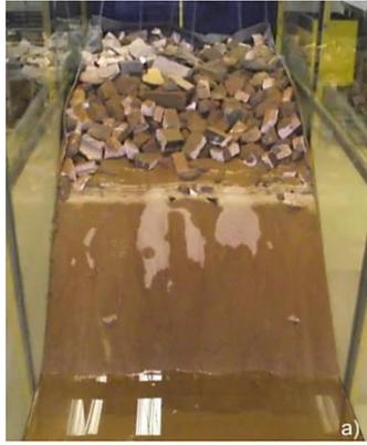
Figura 5.23 – Areia erodida depositada sobre o RCD-R no ensaio com areia sem filtro.
