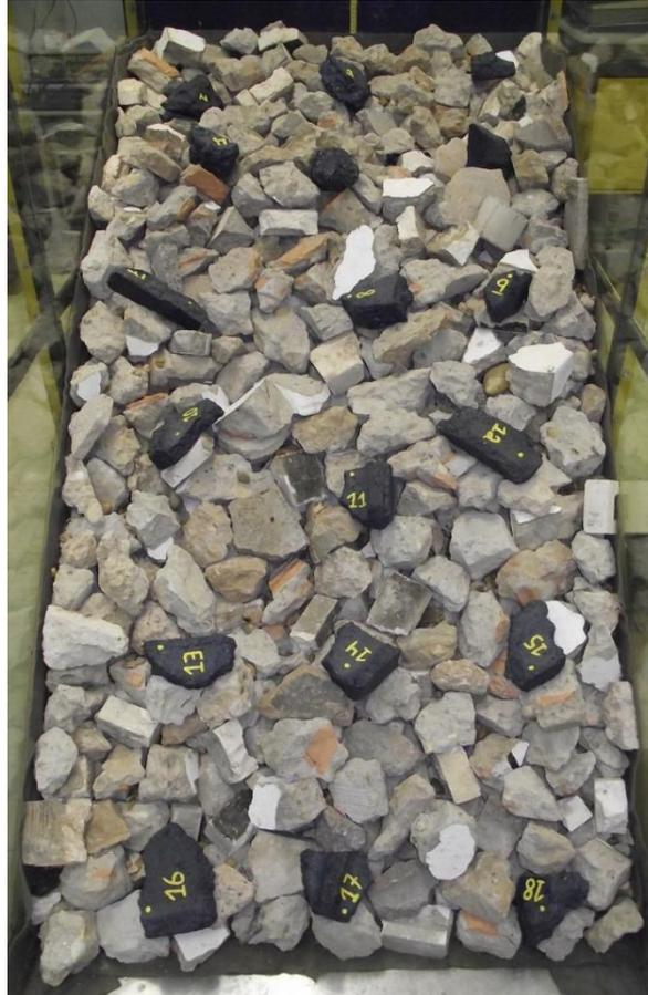
Figura 4.8 – Localização dos agregados RCD-R numerados.
