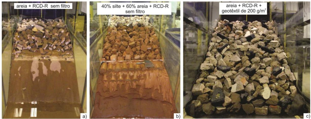
Figura 5.20 – Vista do talude ao término do ensaio: a) areia + RCD-R sem filtro, b) 40% silte + 60% areia sem filtro, c) areia + RCD-R + geotêxtil de 200 g/m<sup>2</sup>.
