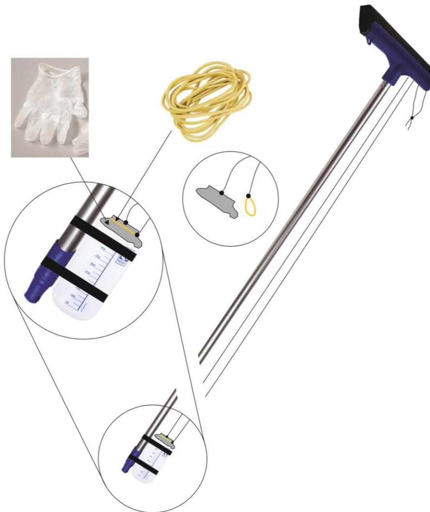
Figura 4.15 – Equipamento utilizado para a coleta de água.
