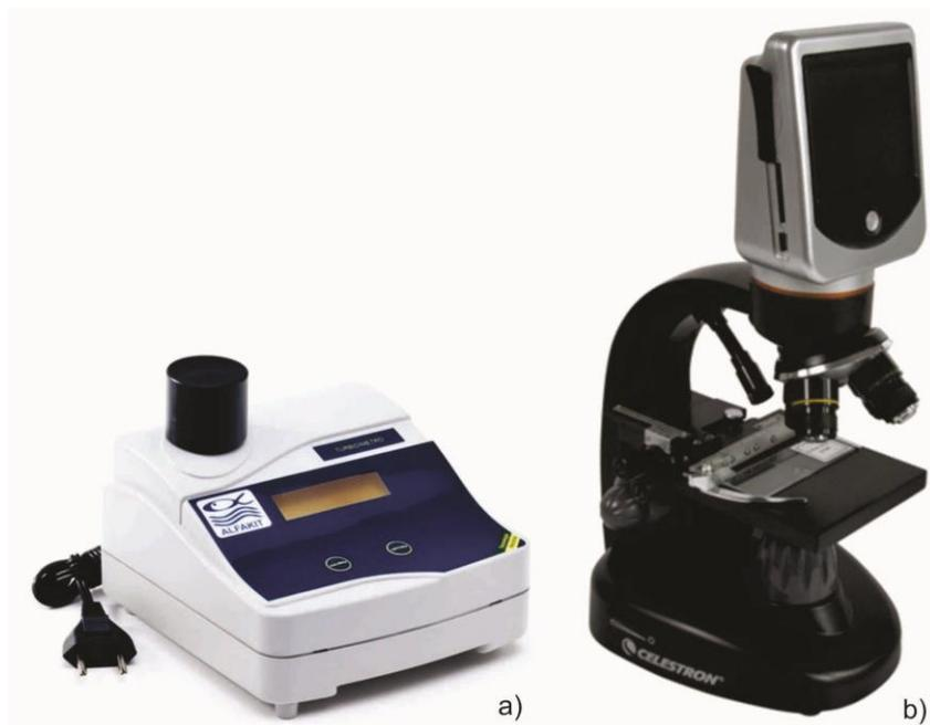
Figura 3.15 – Outros equipamentos: a) turbidímetro, b) microscópio digital.
