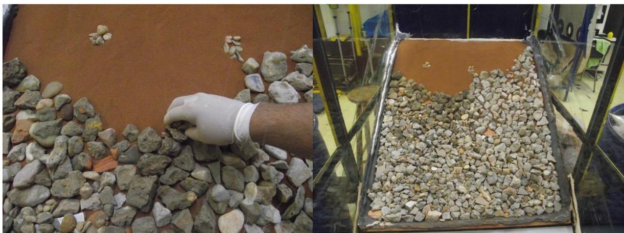
Figura 4.7 - Colocação da 1ª camada de RCD-R no ensaio que utilizou 40% silte + 60% areia + RCD-R sem filtro.
