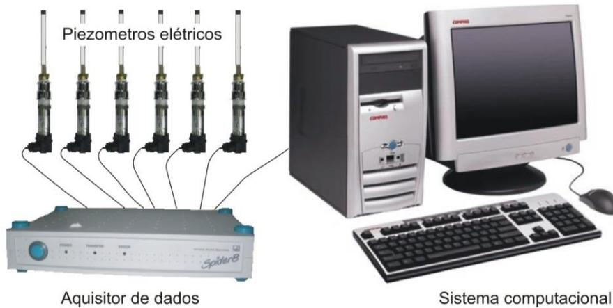
Figura 3.8 – Sistema para medição de poropressões.
