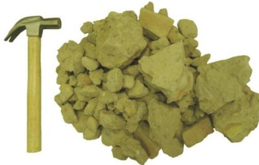
Figura 3.20 – Resíduo da Construção e demolição Reciclado (RCD-R).
