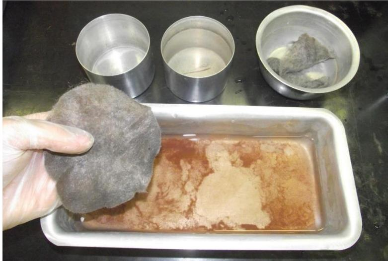
Figura 4.11 – Retirada do solo impregnado do geotêxtil.
