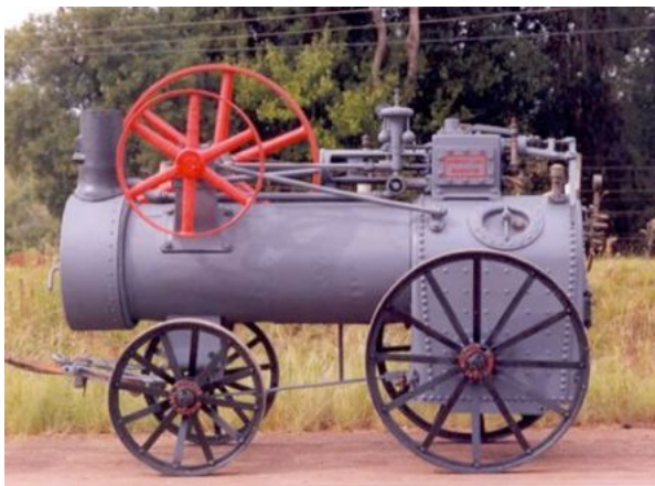
Locomóvel usado para gerar eletricidade nos séculos XIX e XX. Fonte: Memória Virtual, 2012.
