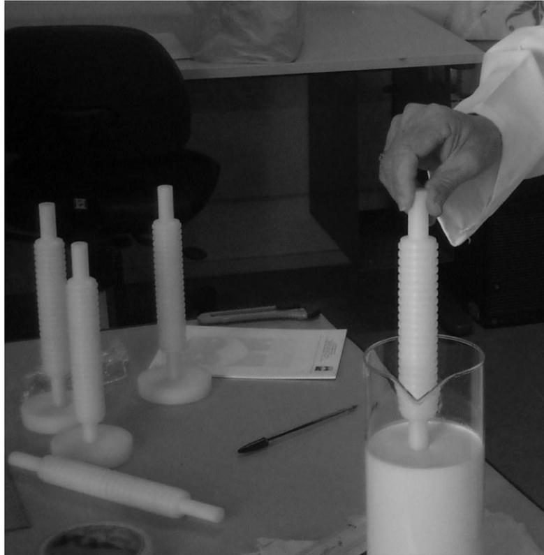
**Figura 6: Imagem dos moldes posicionados e a realização do banho de imersão do molde na mistura do látex.**
