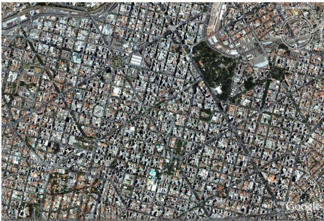
Figura 3.9: Estrutura urbana do tipo misto ortogonal radial exemplificada pelo plano projetado por Aarão Reis para a cidade de Belo Horizonte/MG.
