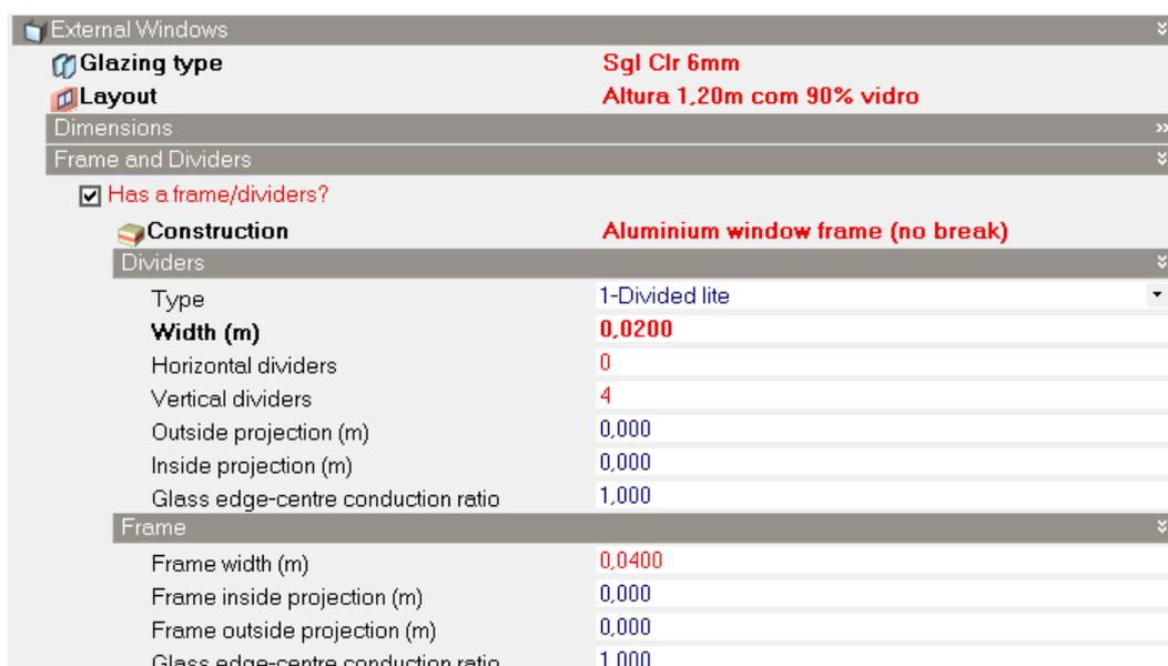
Figura N4 – Material utilizado para as janelas e porta da varanda
