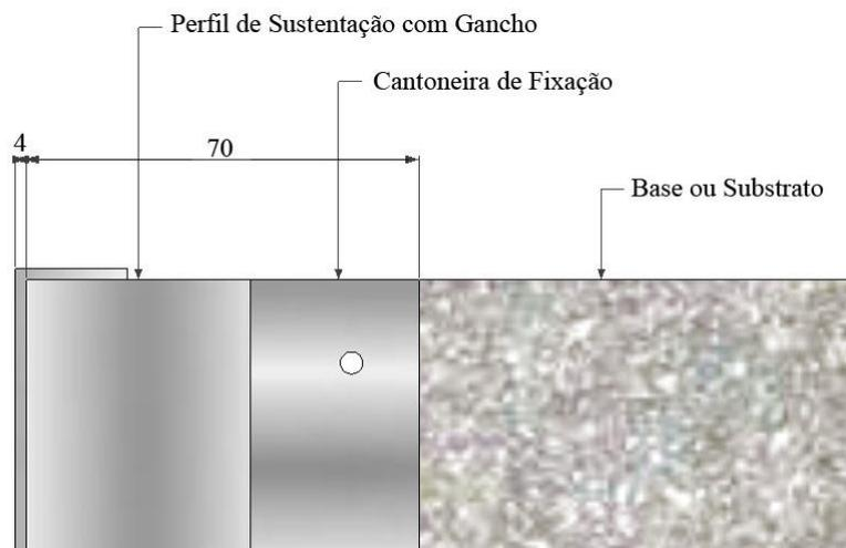
Figura 3.17 - FVACM em corte esquemático – unidades em mm
