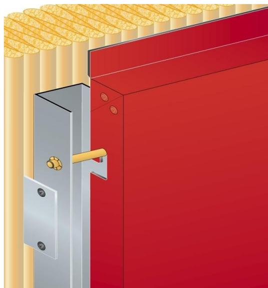
Figura 3.19 - Detalhe da fixação do painel de ACM no perfil (ALUCOMAX, 2013)
