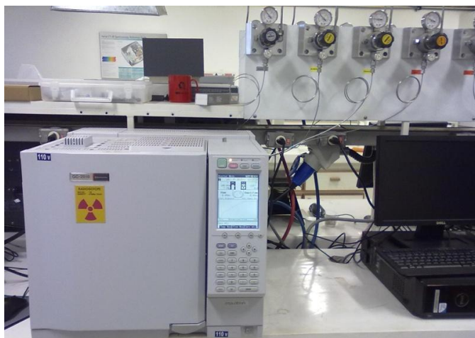
Figura 10. GC-ECD, Shimadzu CG-2010, localizado na Central Analítica do Instituto de Química da Universidade de Brasília (CAIQ-UnB).
