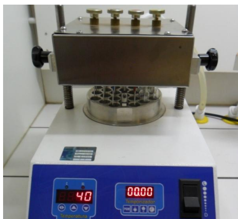
Figura 9. Aparelhagem utilizada para aplicação de fluxo de nitrogênio para concentração dos extratos obtidos a partir de amostra de mel.
