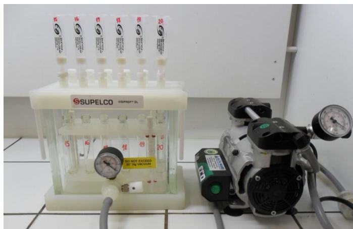
Figura 8. Manifold utilizado para realizar a eluição dos cartuchos de extração em fase sólida (SPE) para extração dos agrotóxicos fipronil e imidacloprido em mel.
