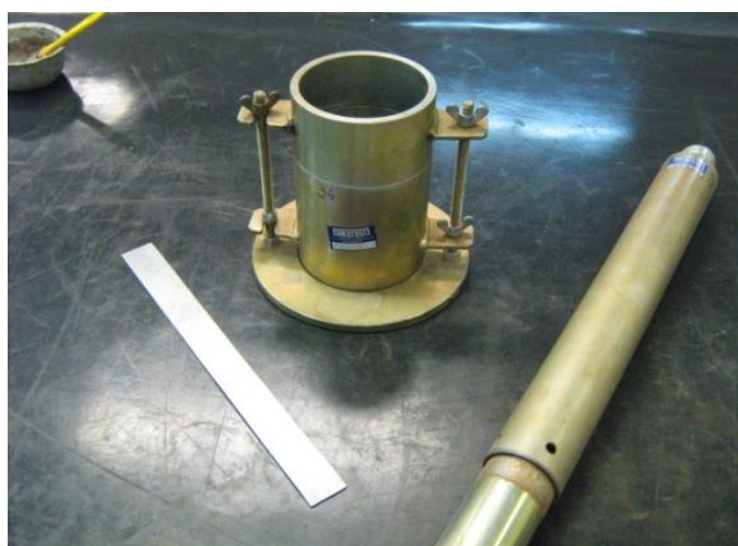
Figura 3.2. Equipamento utilizado no ensaio de compactação proctor normal.
