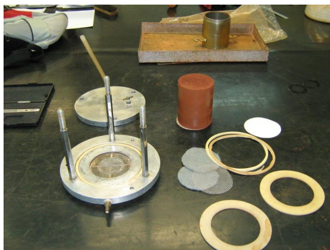
Figura 3.5. Matérias utilizados na montagem do permeômetro.
