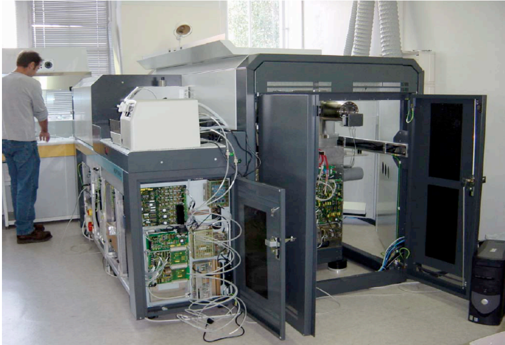
Figure II-10: Photographie du MC-ICP-MS Thermofinnigan Neptune du laboratoire GET (Toulouse).
