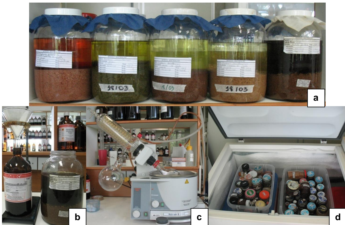
Figura 43 – (a) Processo de extração por maceração. (b) Filtração para obtenção da solução extrativa. (c) Concentração em rota- evaporador. (d) Armazenamento do extrato bruto a -4\text{ }^{\circ}\text{C} .
