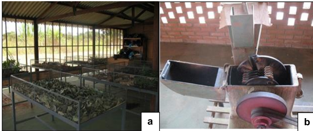
Figura 42 – (a) Dessecação e estabilização dos diferentes órgãos vegetais. (b) Moinho de facas utilizado na pulverização dos órgãos vegetais.
