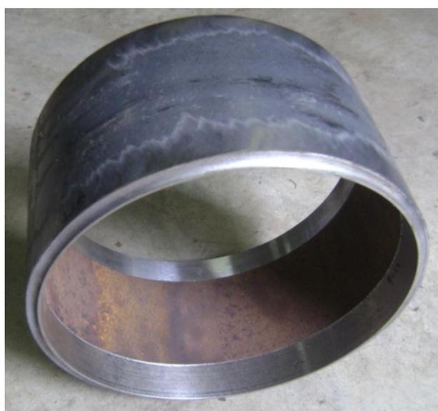
Figura 4.7 – Seção de tubo a ser utilizado após as diversas etapas de usinagem
