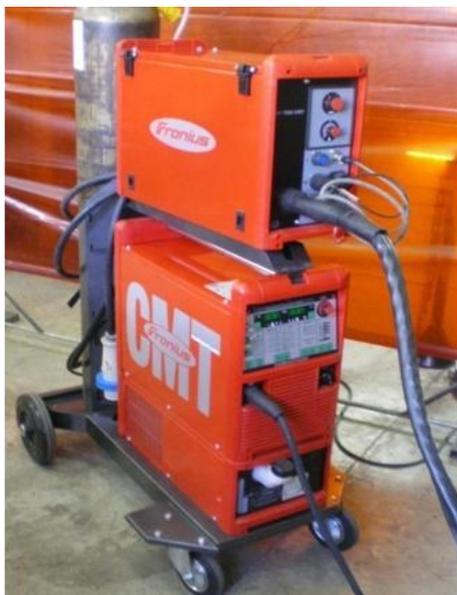
Figura 4.16 – Fonte TPS 5000 CMT, utilizada na soldagem com o processo CMT
