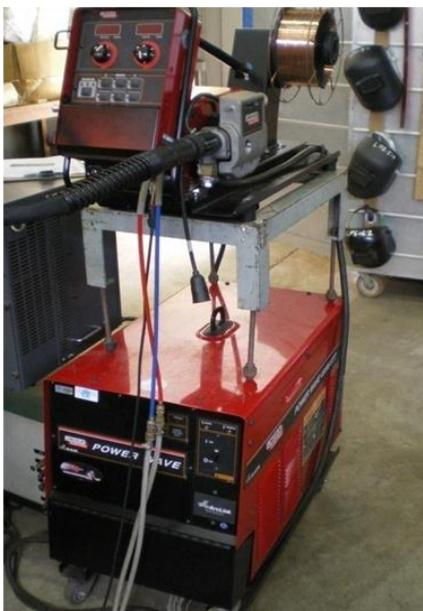
Figura 4.14 – Fonte *Power Wave 450/STT* com alimentador de arame *Power Fedd 10M* da *Lincoln Electric*, usada para o processo STT e curto-circuito convencional
