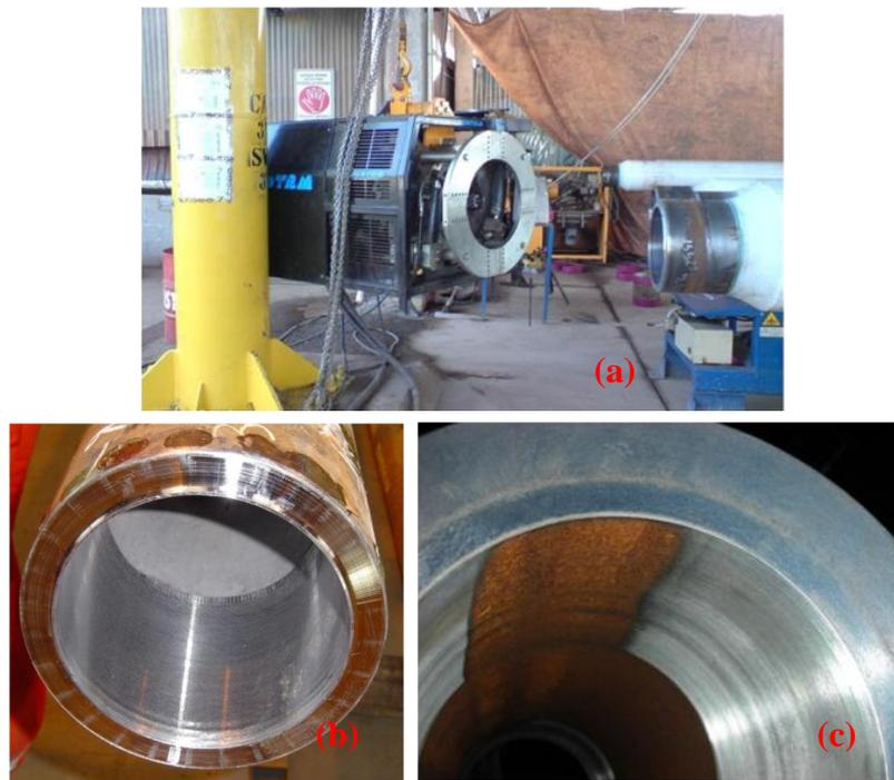
Figura 2.33 – (a) *Counterboring Tool*, diâmetro interno do tubo: (b) homogêneo e (c) não homogêneo, após processo de usinagem (Clarke and Gooch, 2011)
