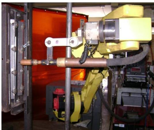
Figura 4.17 – Braço mecânico Arc Mate 100 iBe com 6 graus de liberdade da FANUC
