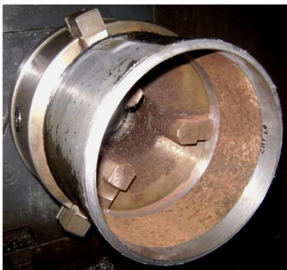
Figura 4.5 – Seção do tubo durante o processo de usinagem de uniformização do diâmetro interno e faceamento
