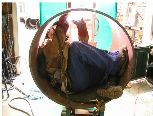
Figura 2.23 – Soldagem semiautomática de passe de raiz pela parte interna do tubo
