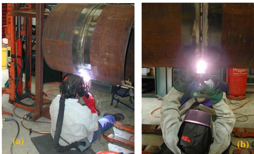
Figura 2.22 – Soldagem semiautomática (a) vertical descendente e (b) sobrecabeça
