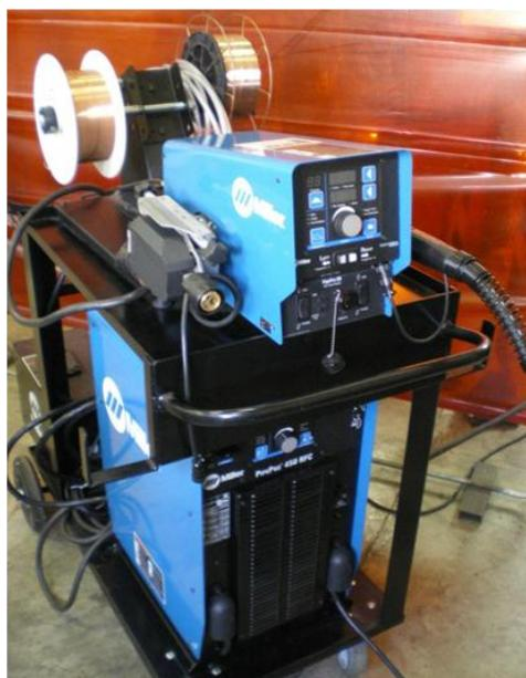
Figura 4.15 – Fonte *PipePro* 450 RFC com alimentador de arame *PipePro* Dual DX usada para soldagem com o processo RMD
