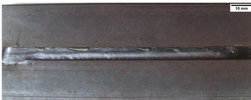
Fig. 5.26 – Face do cordão desviado depositado na junta com nariz inclinado para o valor de comprimento de arco de +30 com CMT
