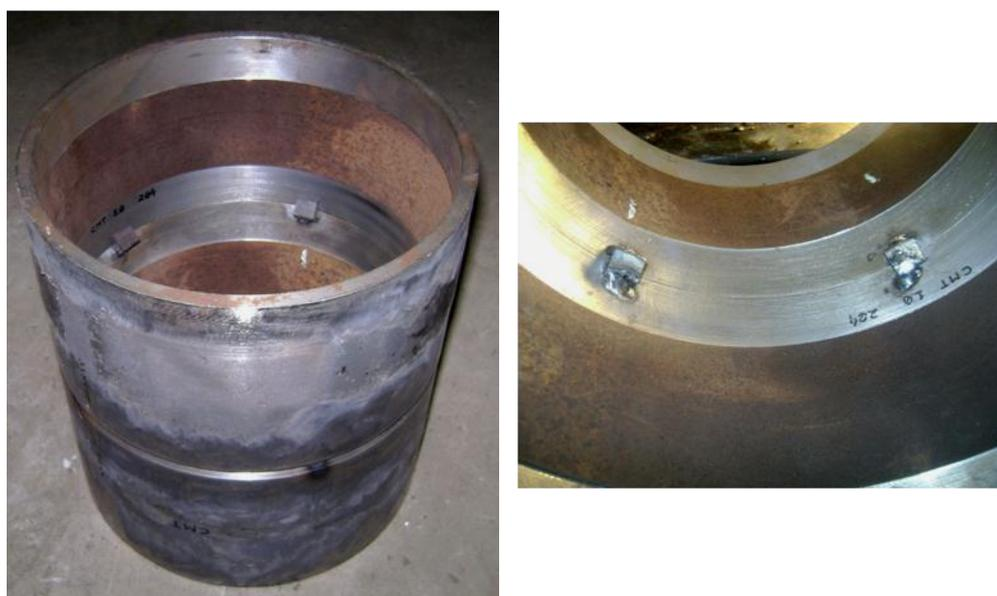
Figura 4.8 – Configuração final de tubos prontos para soldagem e detalhes da fixação e alinhamento entre eles
