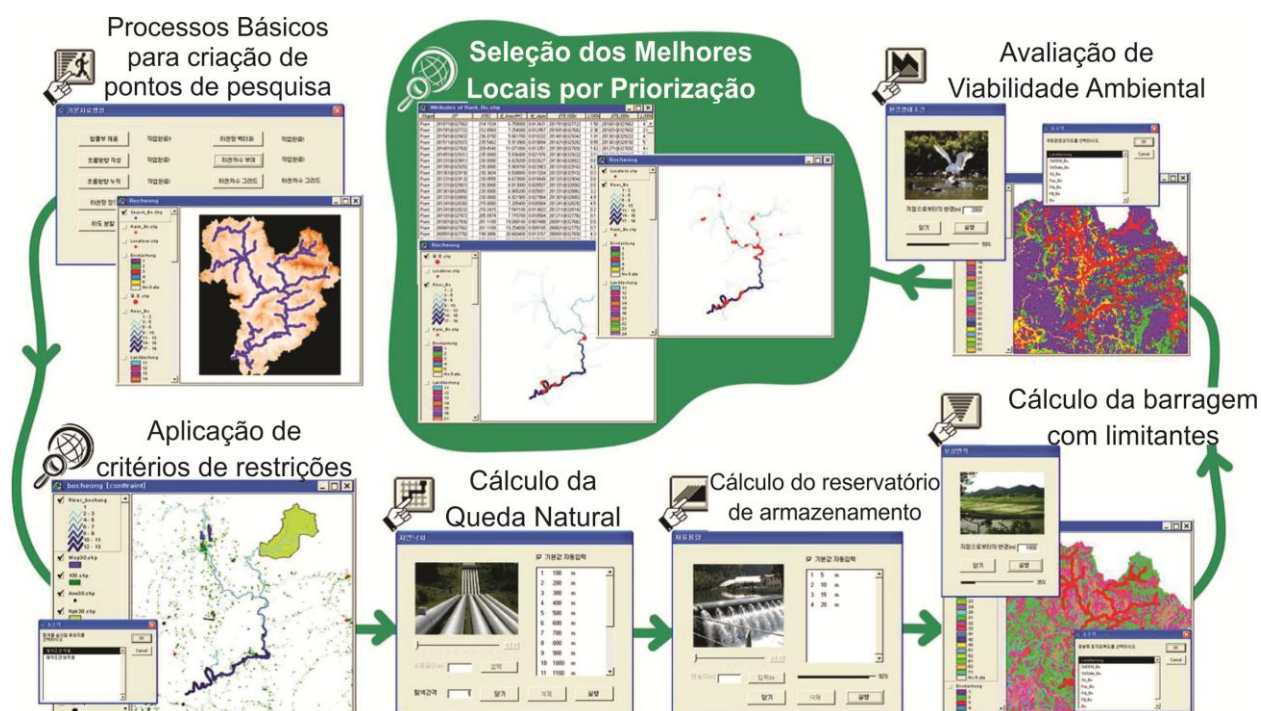
Figura 2.3. Framework para análise de localização de sítio para pequena usina hidroelétrica utilizando sistema de informação geoespacial. Fonte: Yi et al. (2010).
