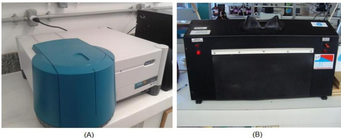
**Figura 10.** Equipamentos utilizados no trabalho (A) Espectrofluorímetro Varian (B) Gabinete de Fluorescência Prodicil.
