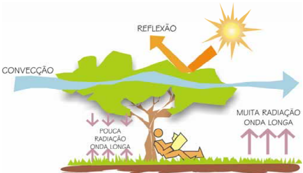
Figura 5 – Croqui representa trocas térmicas e a radiação por ondas longas. Fonte: Lamberts et al. (1997, p.35).
