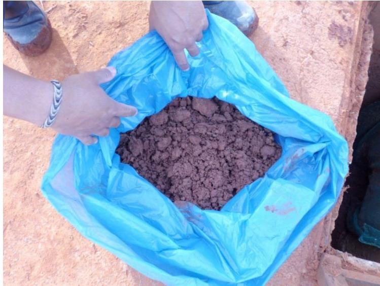
Figura 4. 39 - Sedimentos coletado após atingir na boca de lobo 5 cm de altura
