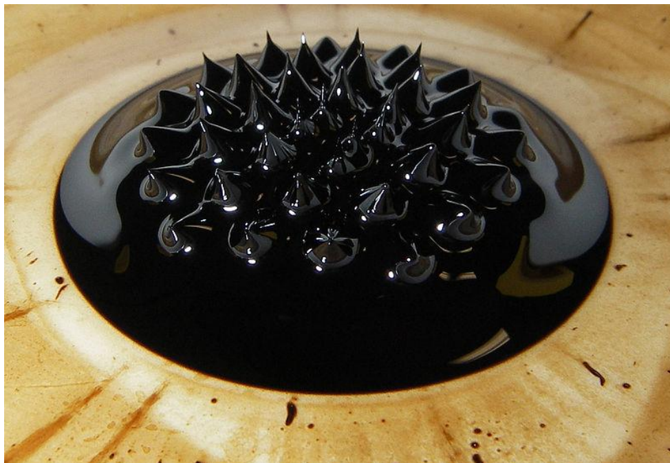
Figura 2 - Ferrofluido sob a ação do campo magnético produzido por um ímã. (Autor: Steve Jurvetson, Flickr)
