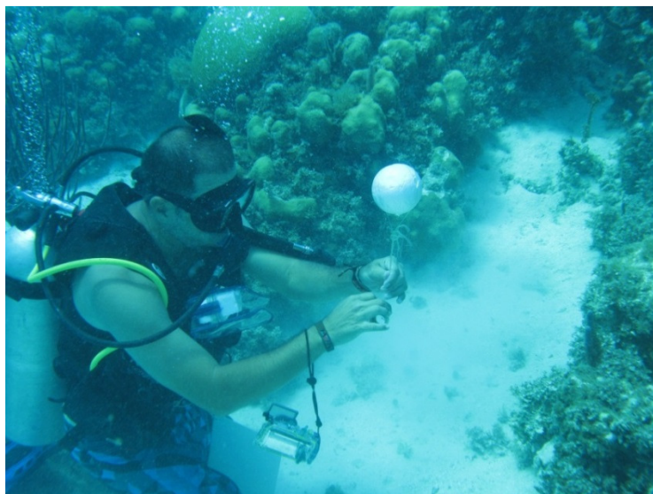
Figura 15: Instalação de Boia de posicionamento
