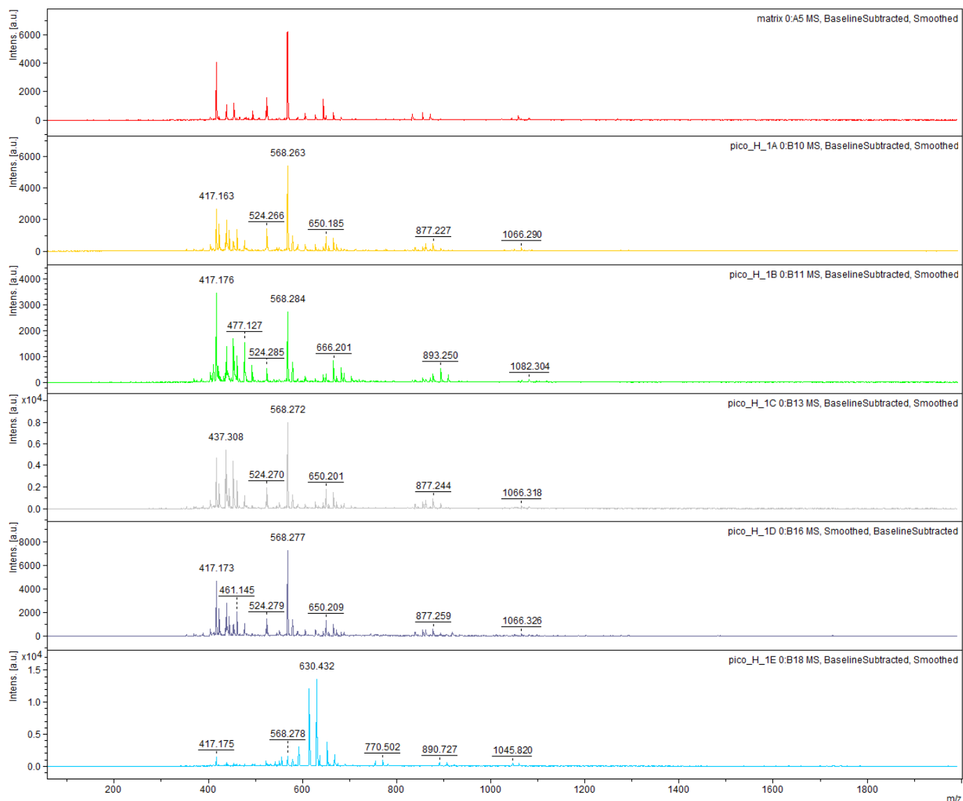
Figura 6: Espectros de massa obtidos para T. asperellum preparadas a partir das amostras fragmentadas da fração “H” estão indicadas a relação massa-carga (m/z), na faixa entre 200 e 12.000 Da. O primeiro espectro corresponde ao perfil da matriz e os espectros 01 a 05 são correspondentes às frações “H”.
