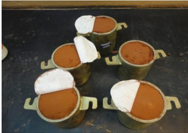
Figura 3.4. Corpos de prova após o ensaio de compactação com cilindro pequeno.
