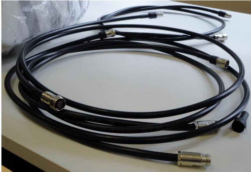
Figura 3.16. Cabos coaxiais que conectam as transições com o VNA.
