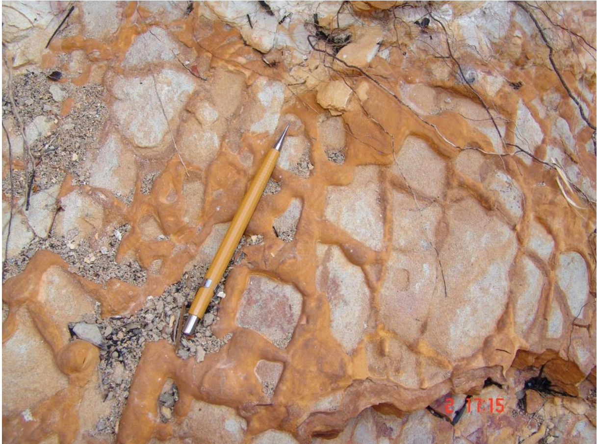
Figura 4.7 – “Metassiltito” alterado, com fraturas preenchidas por óxidos/hidróxidos de ferro
