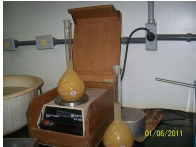
Figura 3.6 – Ensaio de sedimentação em amostras de solo: (a) dispersor; (b) pesagem dos picnômetros
