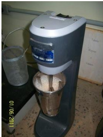
Figura 3.6 – Ensaio de sedimentação em amostras de solo: (a) dispersor; (b) pesagem dos picnômetros
