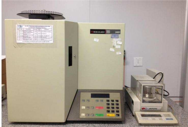
**Figura 5.6:** Aparelho CHNS/O Perkin Elmer e balança de precisão.
