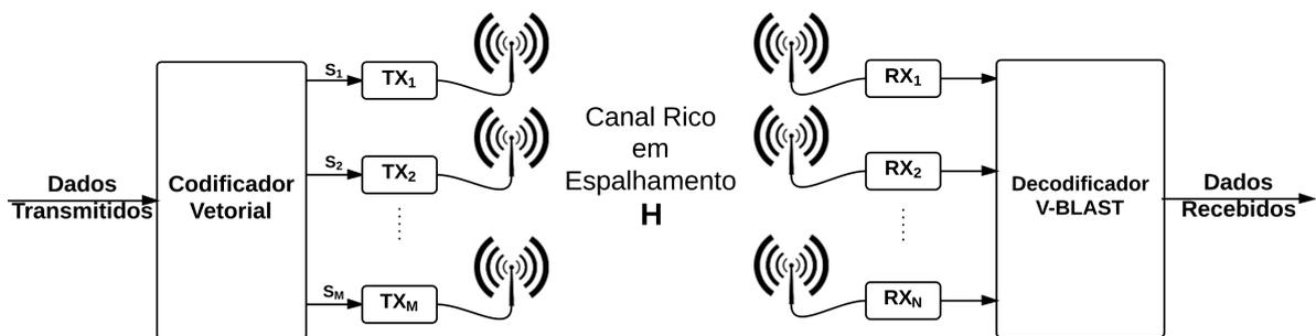
Figura 3.1: Arquitetura V-BLAST: diagrama de alto nível do sistema com  $M$  antenas transmissoras e  $N$  antenas receptoras [3].
