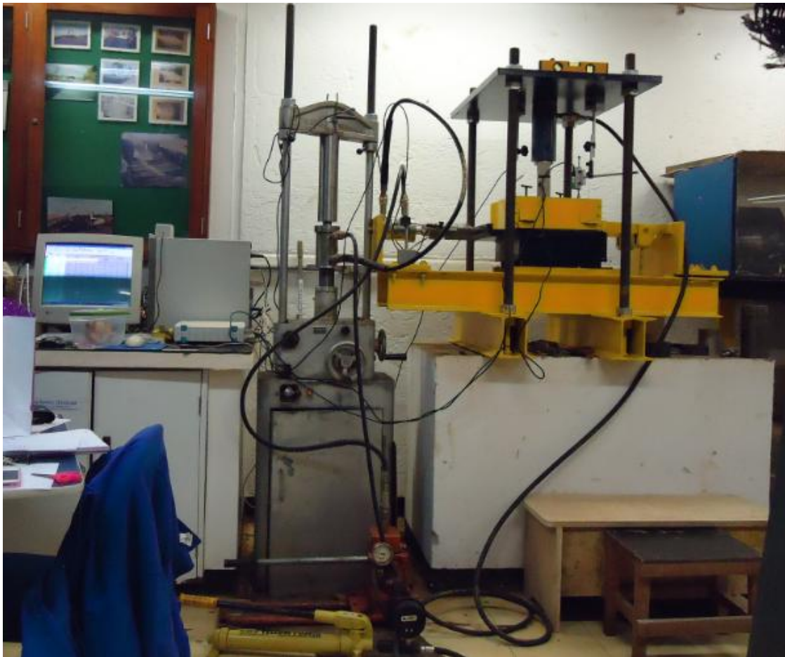
Figura 3.4 – Visão geral do equipamento de cisalhamento direto montado.
