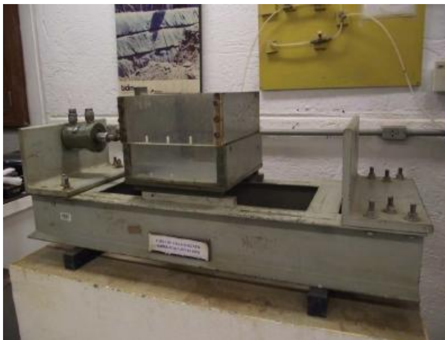
Figura 3.1 – Equipamento de arrancamento de geotêxteis.
