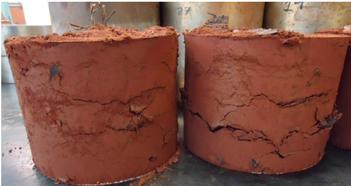
Figura 4.1- Amostra com 5% de compactação, apresentação de fissuras.
