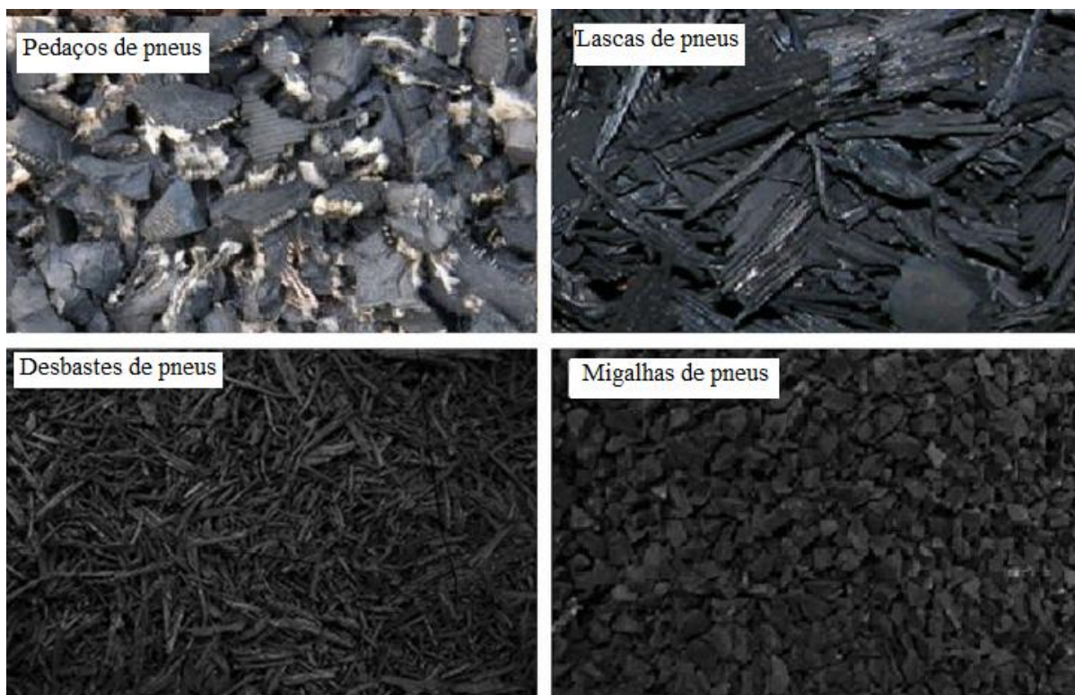
Figura 2.3 - Típicos tipos de diferentes processamentos de pneus inservíveis, fora de escala (EDINÇLILER et al. , 2010).
