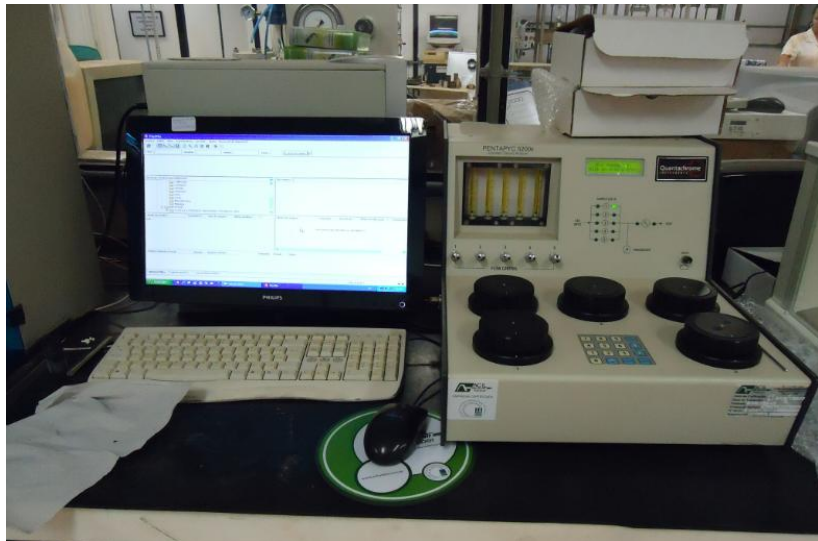
Figura 3.6 – Pentapicnometro modelo pentapyc 5200E.
