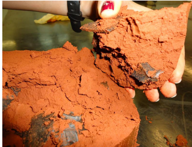
Figura 5.8- Plano de fraqueza da mistura: entre o solo e os pedaços de borracha.
