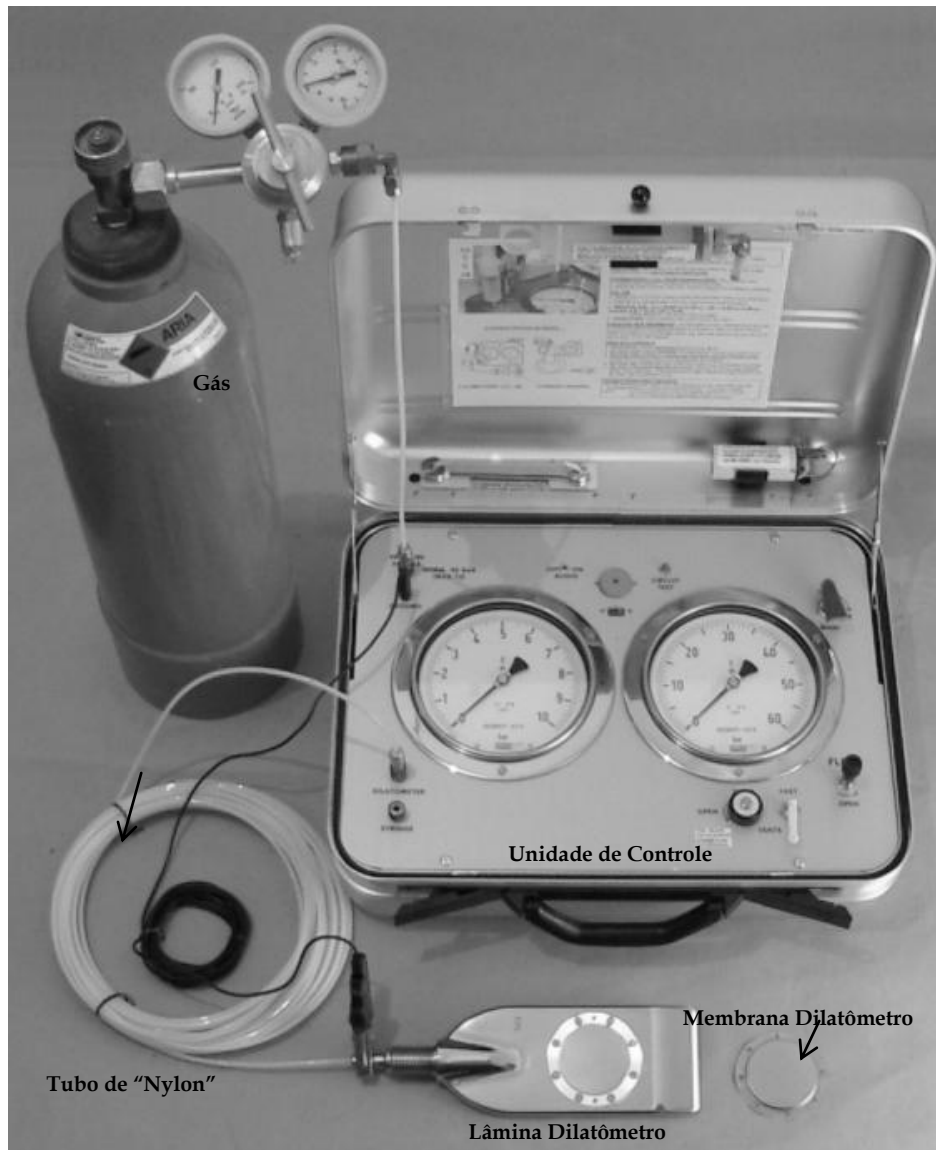
Figura 5. O dilatômetro e alguns dos seus acessórios.
