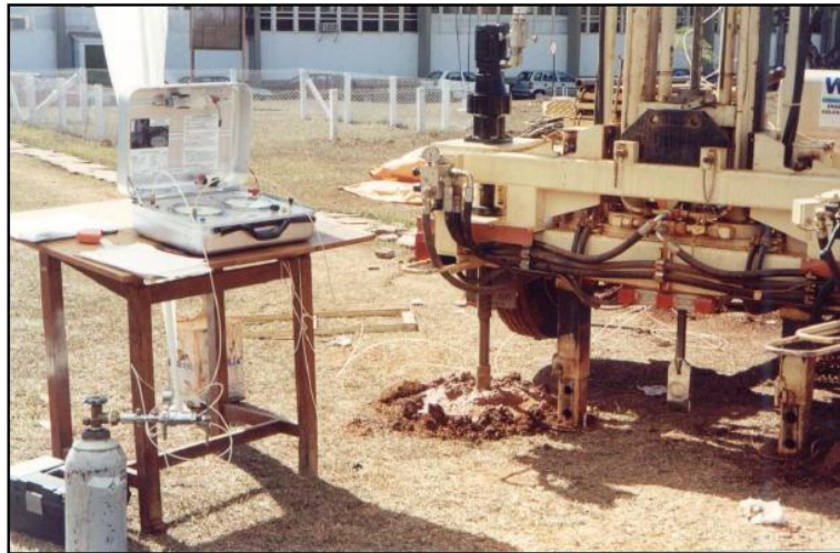
Figura 38. Ensaio de DMT realizado no campo experimental da UnB (Mota 2003).
