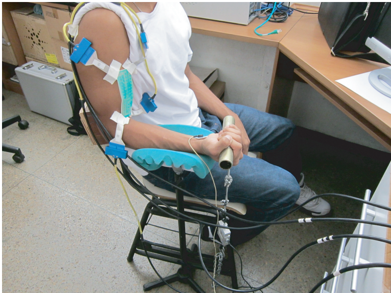
Figura 4.7: (a) Posicionamento do voluntário em uma cadeira com suporte acolchoado para o braço. O cotovelo faz um ângulo de 90^\circ . A alça da célula de carga é posicionada sobre a mão de forma que o punho permaneça reto. (b) Detalhe do posicionamento da matriz de eletrodos.
