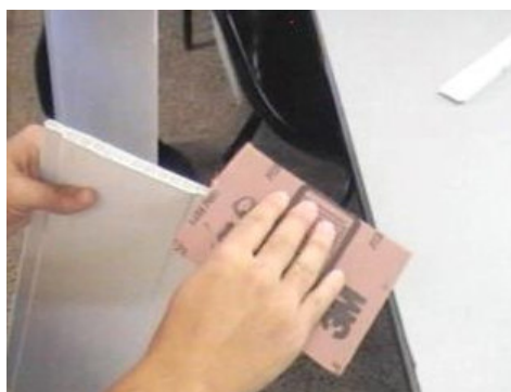
Figura 4: lixa para retirar as rebarbas das placas. Autor: Antonio Martins Ferreira Neto.
