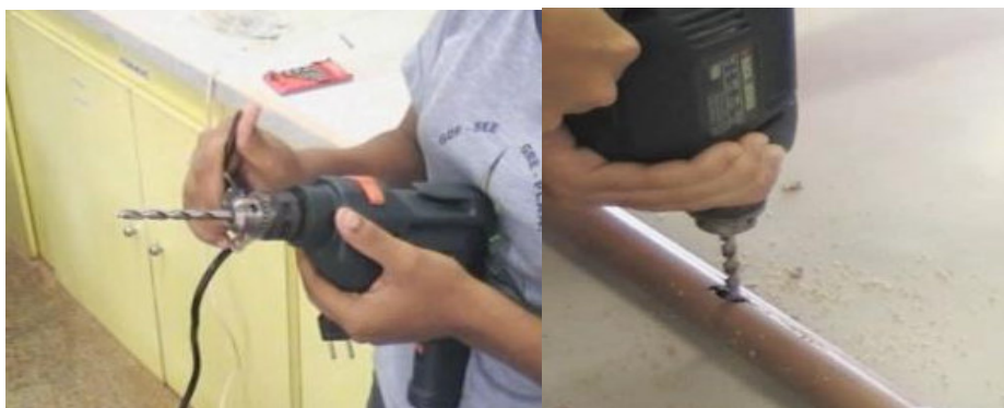
Figura 9 (esquerda) e 10(direita): ajustando a broca e perfurando o cano respectivamente. Autor: Antonio Martins Ferreira Neto.
