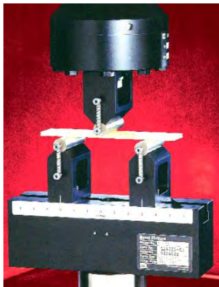
Figura A.2 – Apoios para realização de ensaios de flexão.
