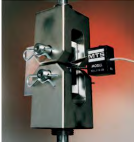
Figura A.6 – Montagem para ensaios de propagação de trinca por fadiga.
