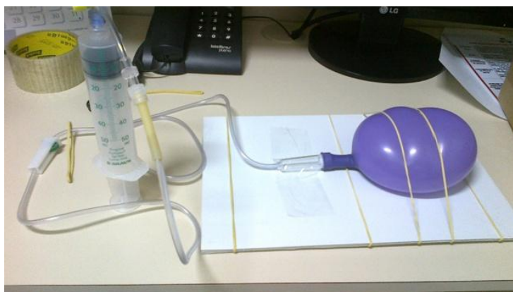
Figura 14 – Sistema para simulação do ciclo respiratório.
