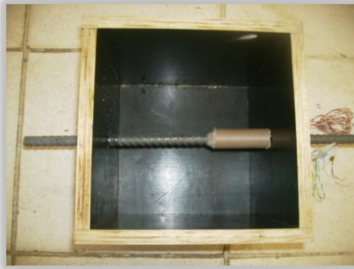
Figura 3.32 – Forma para o ensaio de arrancamento.
