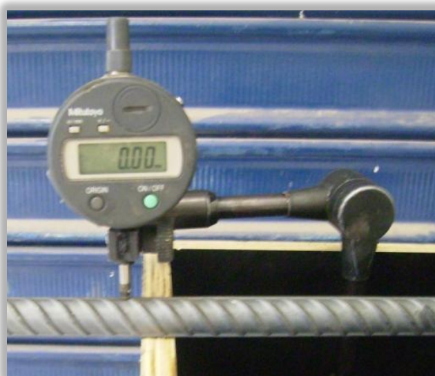
Figura 3.10 – Equipamento e esquema usado para medida da altura das nervuras.
