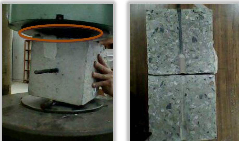
Figura 3.25 – Ensaio para seccionamento do bloco de arrancamento.
