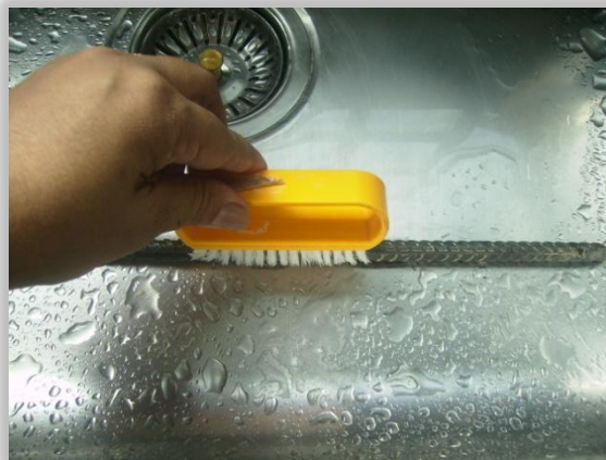
Figura 3.28 – Lavagem e escovação das barras.
