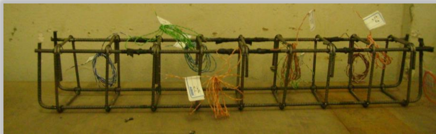
Figura 3.36 – Armadura das vigas.
