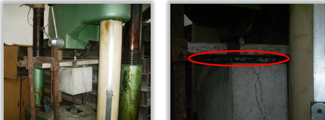
Figura 3.33 – Sistema de ensaio e detalhe da chapa de aço.
