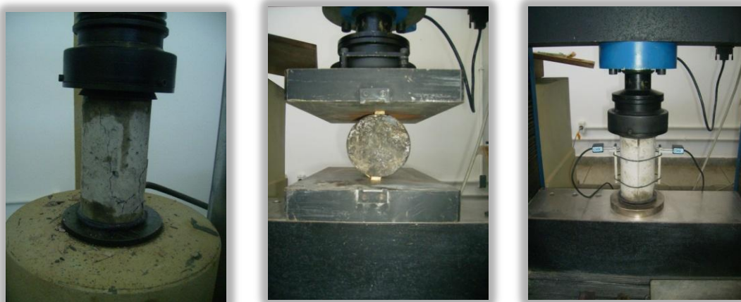
Figura 3.8 – Ensaios de resistência à tração axial, resistência à tração por compressão diametral, e módulo de elasticidade.
