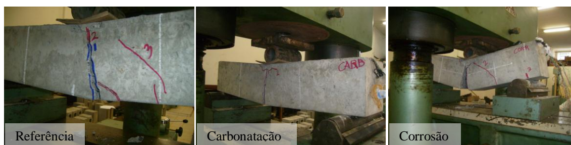
Figura 4.10 – Modos de ruptura das vigas.
