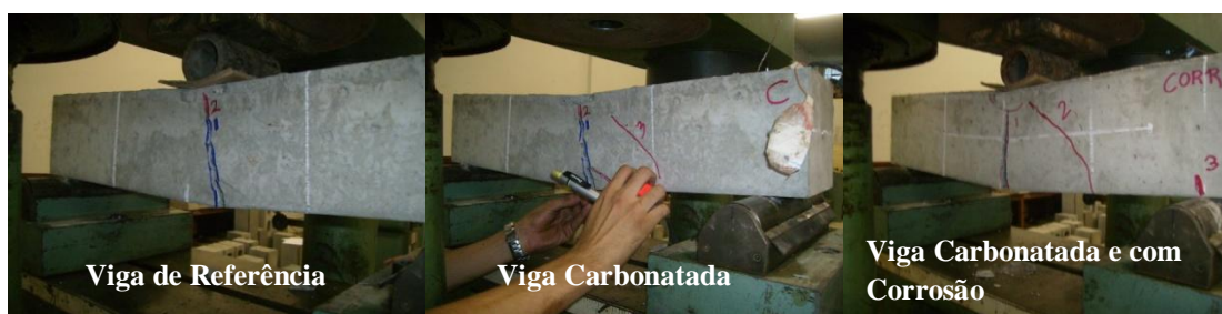
Figura 4.30 – Fissuração das vigas.
