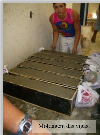
Figura 3.13 – Concretagem dos corpos-de-prova cilíndricos, blocos de arrancamento, tirantes e vigas.
