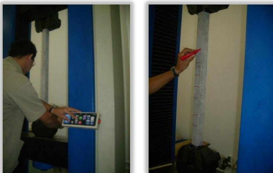
Figura 3.35 – Ensaio do tirante e marcação das fissuras nas quatro faces.
