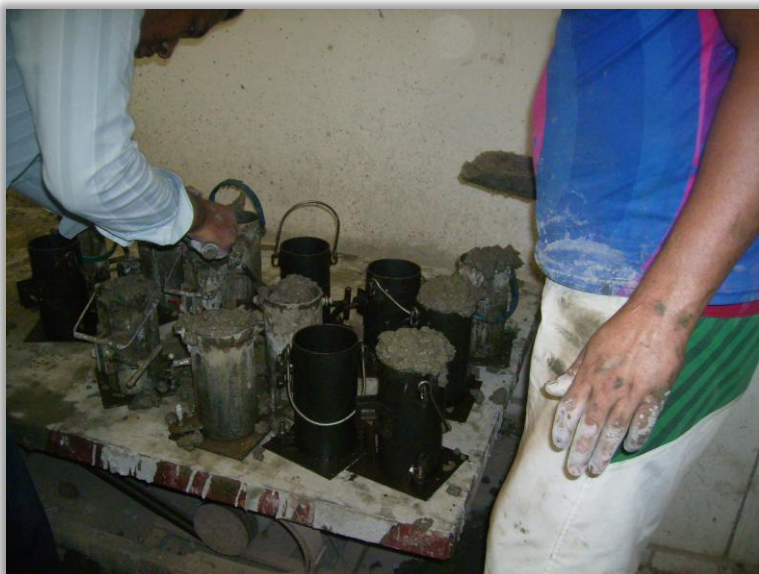
Figura 3.7 – Moldagem dos corpos de prova cilíndricos.
