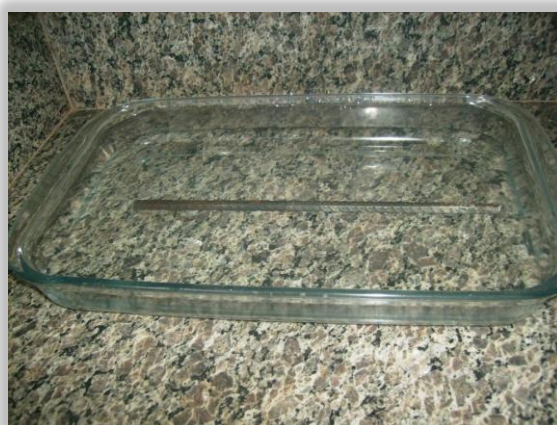
Figura 3.27 – Imersão das barras em solução para remoção dos óxidos composta por ácido clorídrico e hexametilenotetramina.
