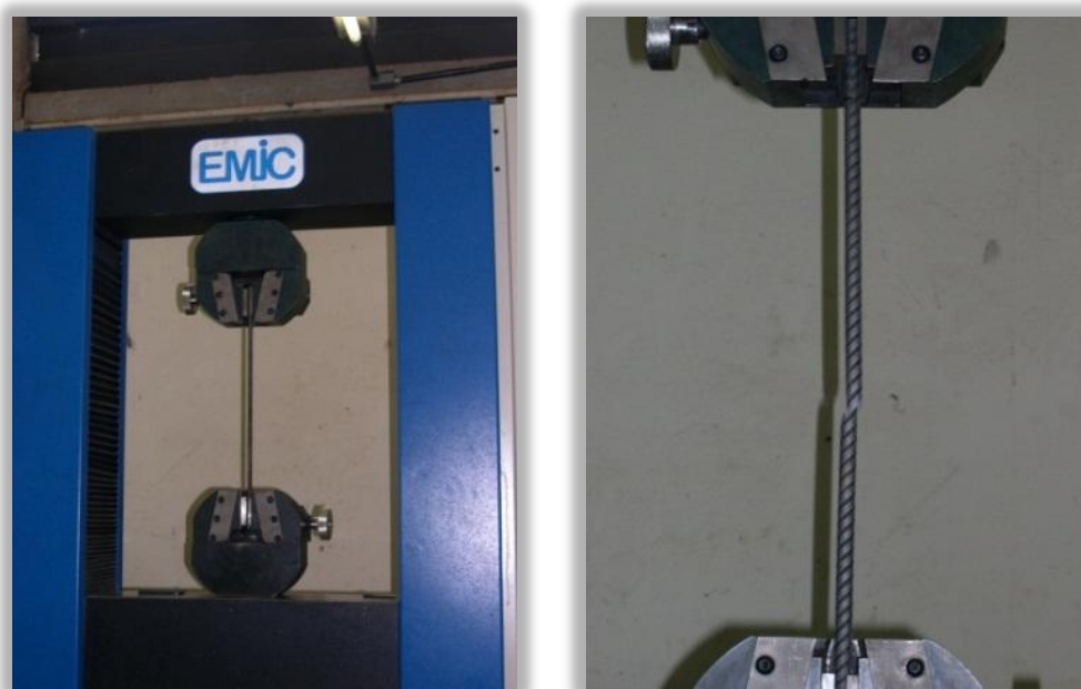
Figura 3.9 – Ensaio de tração do aço.
