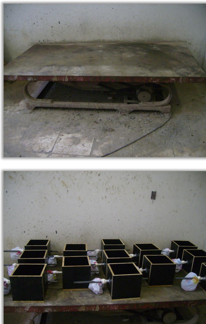
Figura 3.5 – Mesa vibratória para adensamento do concreto.
