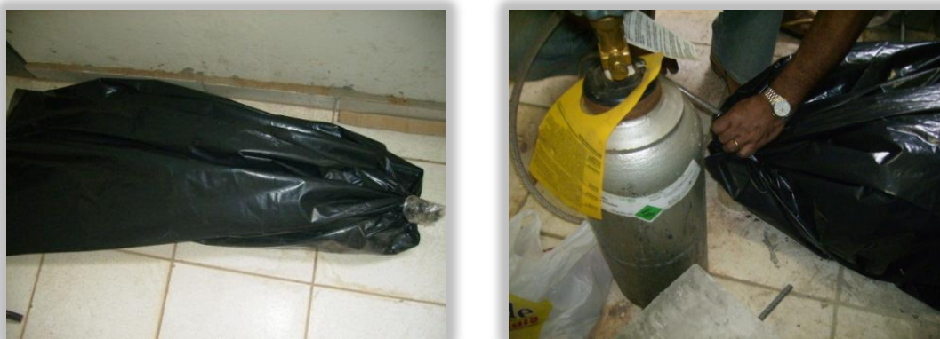
Figura 3.15 – Acondicionamento em sacos plásticos e aplicação do CO 2 (100%) nos blocos de arrancamento, tirantes e vigas.
