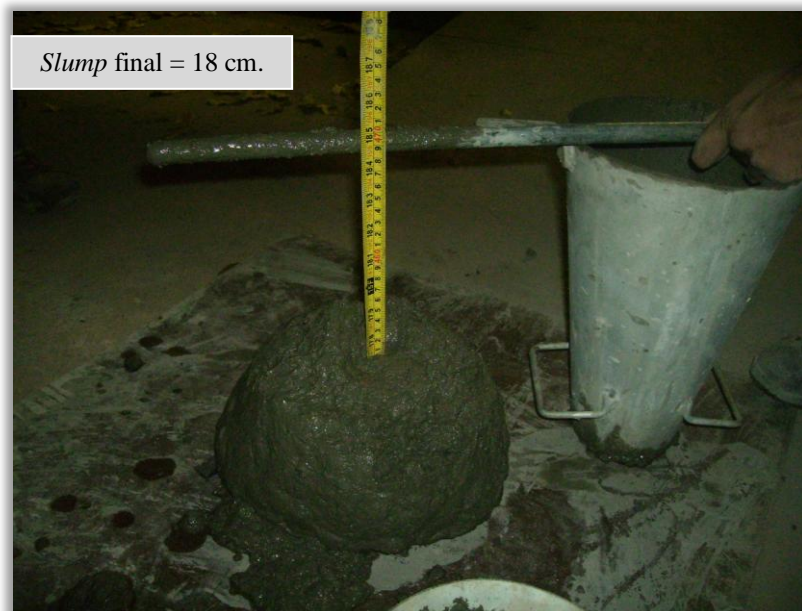
Figura 3.4 – Ensaio de abatimento de tronco de cone ( Slumptest ).
