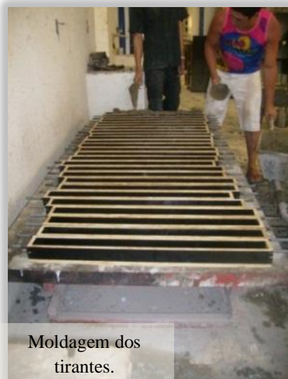
Figura 3.13 – Concretagem dos corpos-de-prova cilíndricos, blocos de arrancamento, tirantes e vigas.
