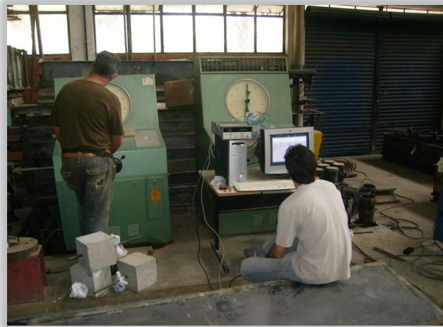
Figura 3.34 – Leitura das cargas e das deformações.
