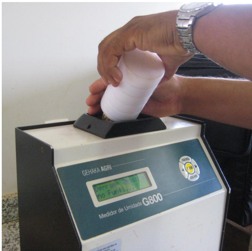
Figura 2.3: Técnico medindo a umidade de uma amostra de soja em medidor de umidade.
