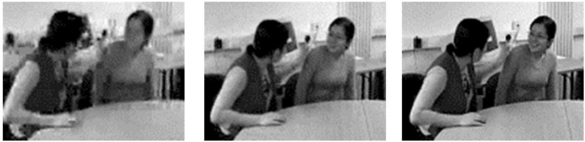
Figura 2.3: Compressão nos padrões MPEG-2, MPEG-4 Visual e H.264/AVC, com bitrate fixo de 150kbps [24].
