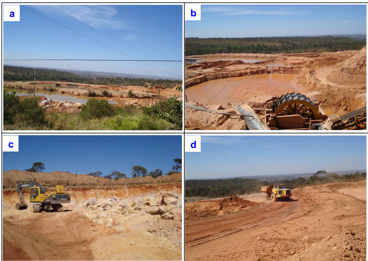
Figura 49 - (a) Vista das instalações do areal. (b) Presença de bacias de contenção das soluções geradas no processo de mineração (depósito de resíduos e fluídos do processo de beneficiamento). (c) Desmonte mecânico (remoção da camada fértil do solo e geração de resíduos sólidos). (d) Transporte interno de minério e rejeito (poluição do ar, por partículas em suspensão – poeiras e gases).
